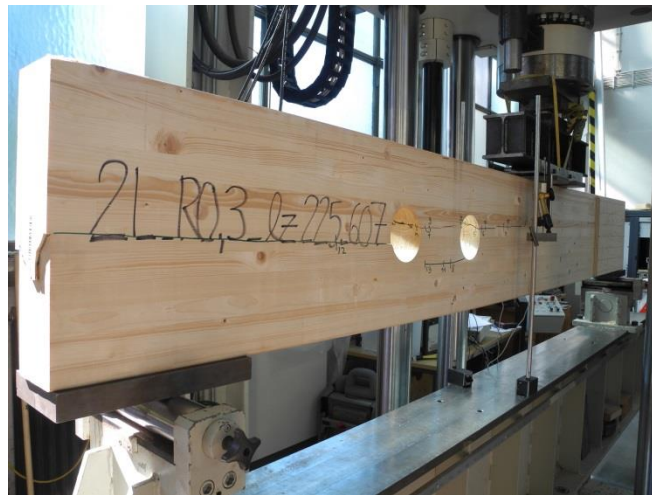
Bild 10: Realisierter Versuchsaufbau mit dem gebrochenem Prüfkörper gemäß Bild 9d
